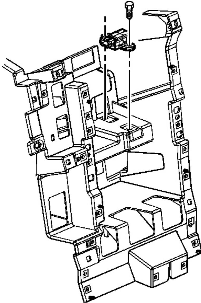
**Fig. 21: Longitudinal Accelerometer**
