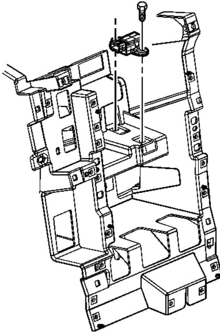
**Fig. 22: Longitudinal Accelerometer**
